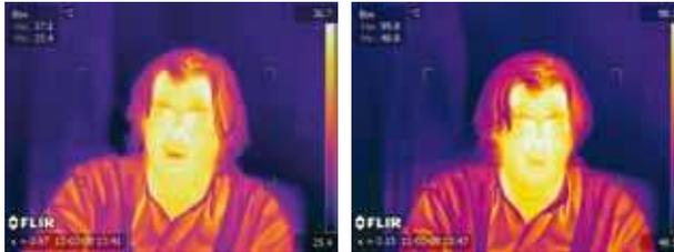
La termografía de la izquierda tiene la configuración de emisividad correcta para la piel humana (0,97) y la lectura de temperatura muestra la temperatura correcta (36,7 °C). En la termografía de la derecha se ha especificado una emisividad incorrecta (0,15), lo que genera una lectura de temperatura falsa (98,3 °C).
