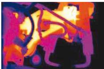
*Punto caliente en robot de soldadura*
