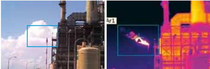
*Una cámara termográfica puede supervisar las llamas que son invisibles a simple vista. Observe que la llama es invisible en la imagen izquierda.*
