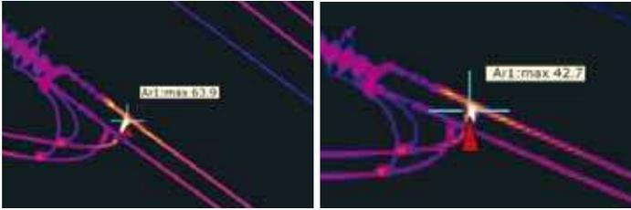
*Una mejor resolución de la imagen también conlleva una mayor precisión de la medición. La termografía de 640 x 480 píxeles de la izquierda muestra una temperatura de 63,9 °C, mientras que la termografía de 320 x 240 píxeles de la derecha indica 42,7 °C*
