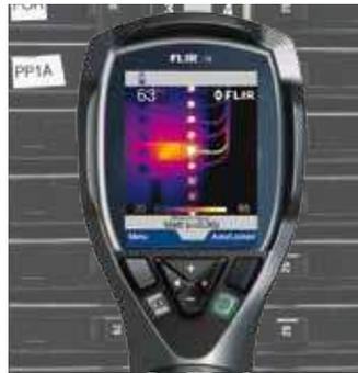
**FLIR i3, temperatura en 3.600 puntos**
