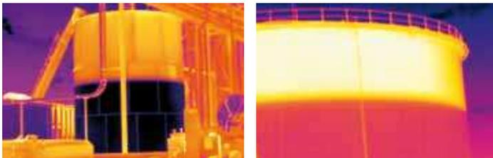
*Estas termografías muestran claramente el nivel de líquido en los depósitos de almacenamiento.*
