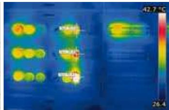
*Esta termografía muestra que la carga no está uniformemente distribuida entre las cajas de fusibles.*
