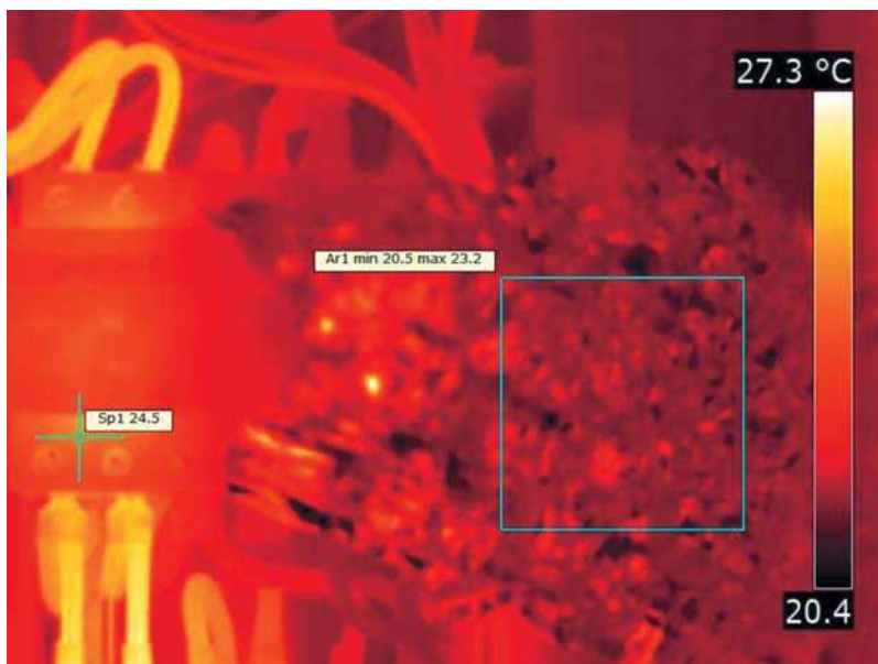
Figura 2. Imagen infrarroja de un papel de aluminio arrugado.
