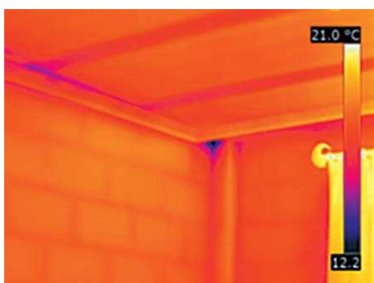
Figura 3. Imagen infrarroja del interior de un local de cemento y ladrillos calefactado a 21 °C.
