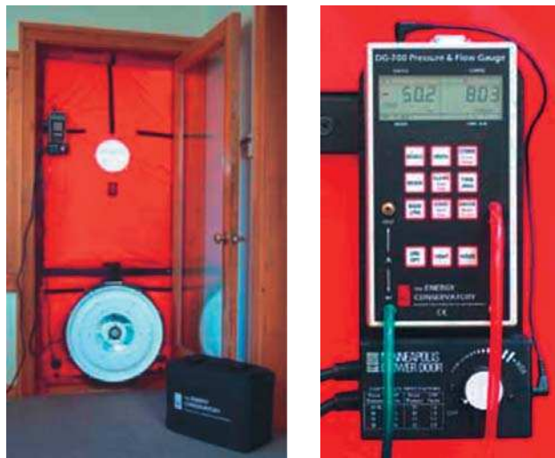
Figura 1. Ejemplo de Blower Door y controlador.
