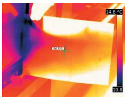
Figura 3. Termograma durante un test Blower Door.
