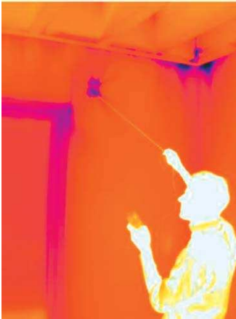
Caja de conexiones eléctricas. Error de construcción.
